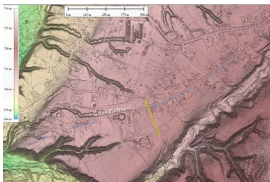
Fig. 4 Cartierul de NE al orașului Câmpulung. Rambleul de la Calea Pietrosă (linie albastră discontinuă); linie galbenă – secțiunea altimetrică de la Fig. 5. Model teren, rezoluție 0,3 m.
